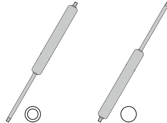
ピストンロッドを下向きにして取り付けいただくことで、本体ピストンロッド側に内部オイルが溜まり、下記の効果を果たします。
